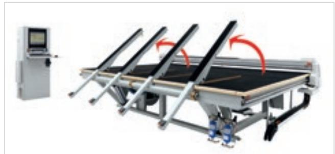
L'opérateur de la machine positionne manuellement la plaque sur la bascule.
