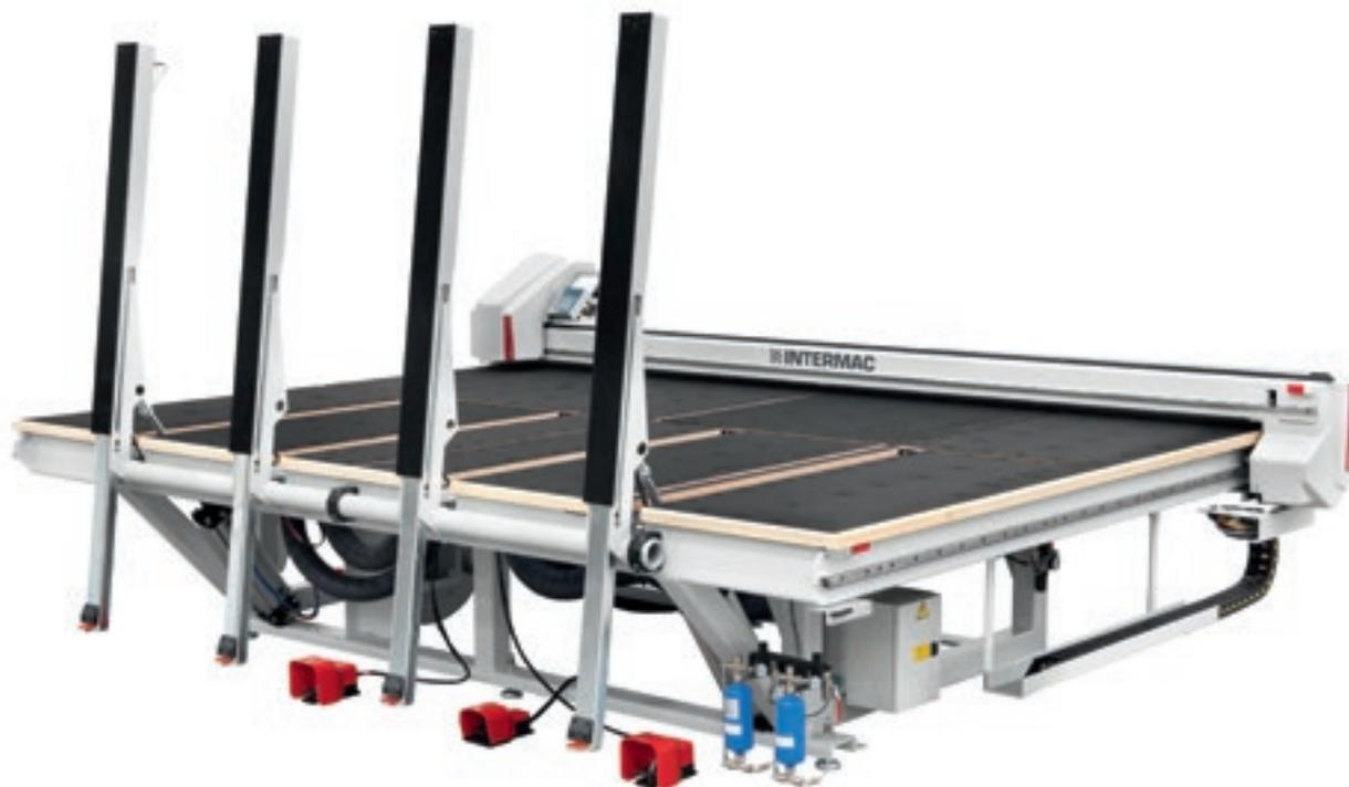
**Genius RS-A offre un encombrement limité même en hauteur grâce à des bras basculants qui ne dépassent pas 2,5 m.**
