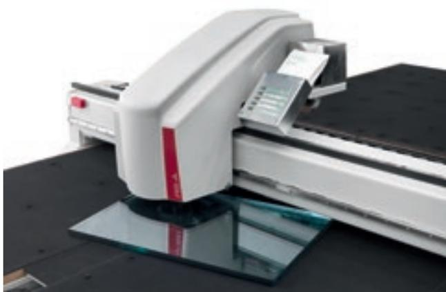
Le lecteur optique appliqué sur le groupe opérateur reconnaît la position de la plaque sur le plan de travail et permet d'effectuer les façonnages sans positionner la vitre à couper en butée, en réduisant les temps d'attente et en garantissant la plus grande précision pour la mise à zéro de la plaque. Ce dispositif se charge également avec une précision extrême de la fonction de double zéro pour la coupe du verre.
