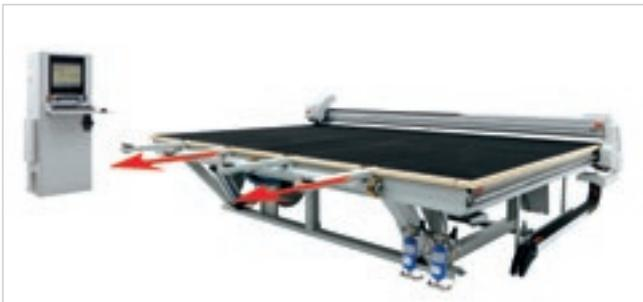
Les bras de la bascule se mettent automatiquement en position de chargement.
